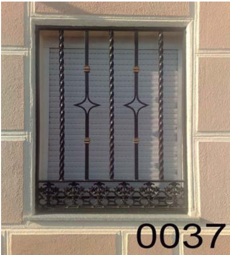
RE-0037: Reja fija modelo de barrotes de macizo de 20*20 mm., solera inferior de fundido, rombos y rizados salomónicos, macollas de latón doradas, imprimación "wash primer" y lacado al horno oxirón verde.
