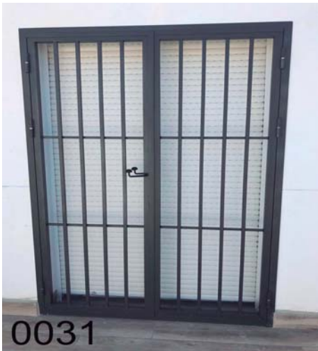
RE-0031: Puerta abatible 2 hojas, pernios con rodamiento axial, cerradura y manivela, modelo simple de barrotes de tubo de 20*20 mm., refuerzos horizontales, imprimación "wash primer" y lacado al horno oxirón gris.
