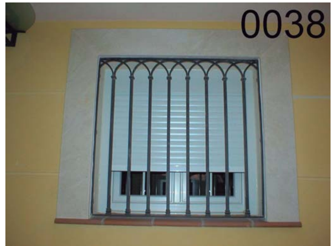
RE-0038: Reja fija modelo de barrotes de macizo de 20*20 mm., parte superior decorativa con arcos cruzados, macollas de fundido, imprimación "wash primer" y lacado al horno oxirón gris.
