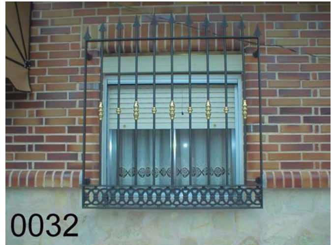
RE-0032: Reja fija modelo de barrotes de macizo de diam. 16 mm., solera inferior decorativa, puntas de lanza, macollas de latón doradas, imprimación "wash primer" y lacado al horno oxirón gris.
