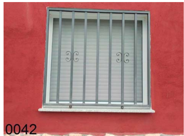
RE-0042: Reja fija modelo simple, barrotes de tubo 25*25 mm., con detalles decorativos en "C" y esferas de fundido, imprimación "wash primer" y lacado al horno gris medio.
