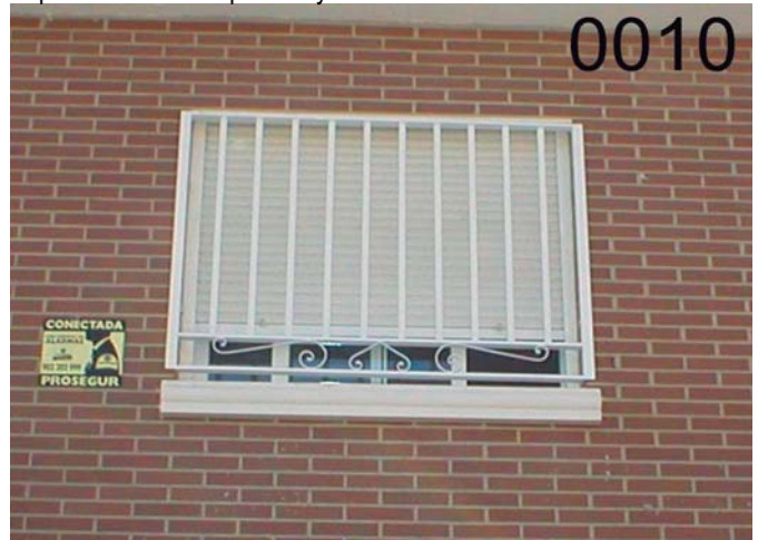
RE-0010: Reja fija modelo simple, barrotes de tubo 20*20 mm., con detalles decorativos en "S" parte inferior de pletina, imprimacion "wash primer" y lacado al horno blanco.
