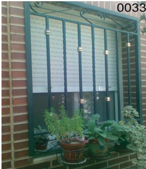
RE-0033: Reja fija modelo de barrotes de macizo de 20*20 mm., fajas superior e inferior decorativas, rizado salomónico, macollas de latón doradas, imprimación "wash primer" y lacado al horno oxirón gris.
