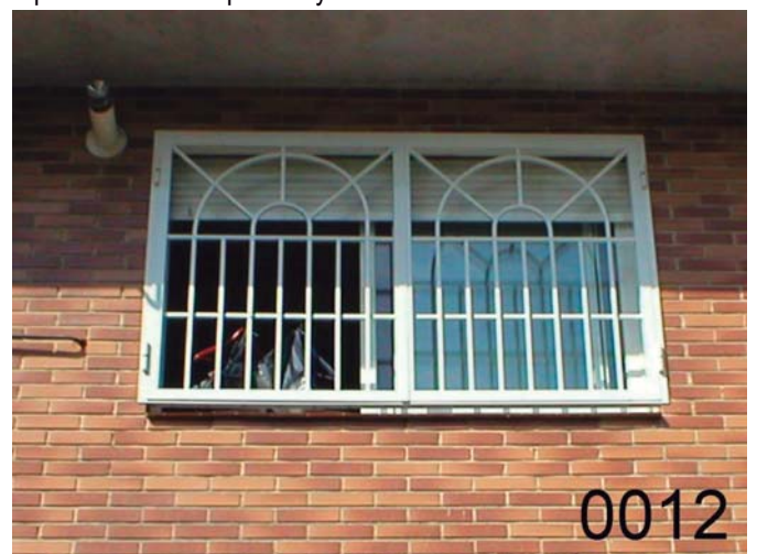
RE-0012: Reja abatible 2 hojas con cerradura, modelo "Estilo Inglés" de acero macizo, barrotes de cuadradillo 16*16 mm., con arcos y radios superiores, 2 refuerzos horizontales, imprimacion "wash primer" y lacado al horno blanco.
