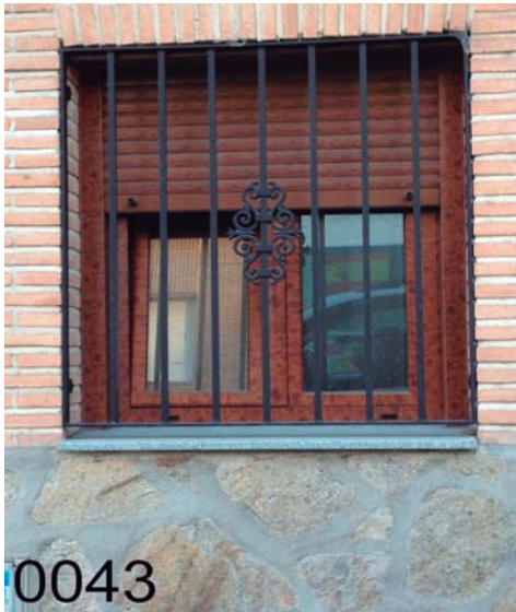
RE-0043: Reja fija modelo de barrotes de macizo de 16*16 mm., adorno central de fundido, imprimación "wash primer" y lacado al horno negro texturado.
