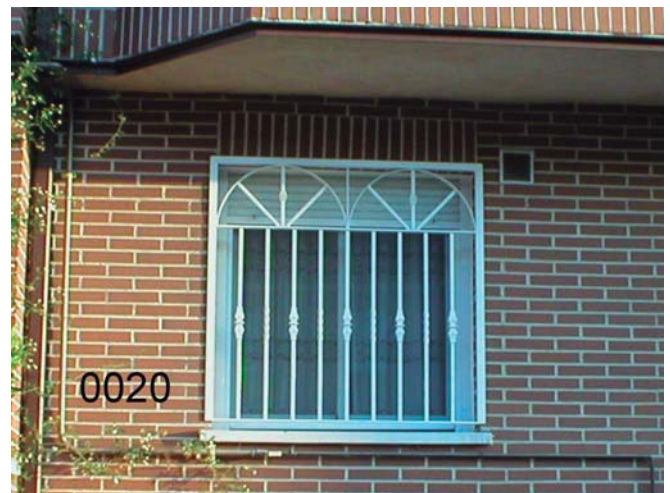
RE-0020: Reja fija modelo "Estilo Ingles" de barrotes de macizo de diam. 16 mm., con macollas de fundido, imprimacion "wash primer" y lacado al horno blanco.
