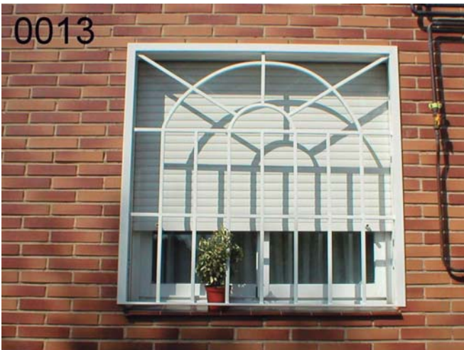
RE-0013: Reja fija "Estilo Inglés" de acero macizo, barrotes de cuadradillo de 14* 14 mm., con arcos y radios superiores, 2 refuerzos horizontales, imprimacion "wash primer" y lacado al horno blanco.
