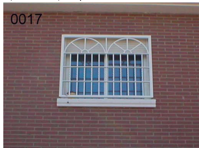
RE-0017: Reja fija "Estilo Inglés" de acero macizo, barrotes de cuadradillo de 16* 16 mm., con arcos y radios superiores, 3 refuerzos horizontales, imprimacion "wash primer" y lacado al horno blanco.
