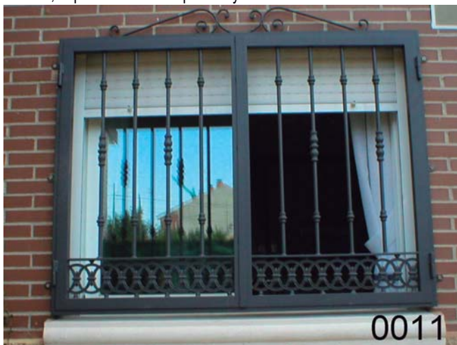
RE-0011: Reja abatible 2 hojas con cerradura, modelo de barrotes de macizo de diam. 16 mm., solera inferior decorativa, macollas de fundido, imprimacion "wash primer" y lacado al horno oxirón gris.
