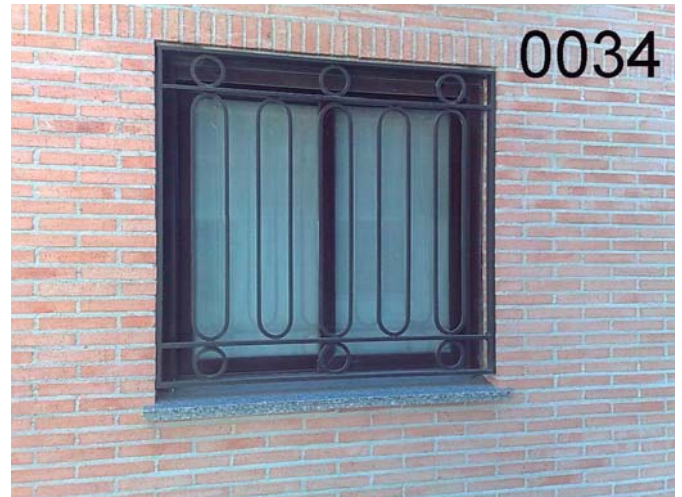
RE-0034: Reja fija de acero macizo, barrotes decorativos con arcos y aros de cuadradillo de 14*14 mm., 2 fajas horizontales, imprimación "wash primer" y lacado al horno blanco.
