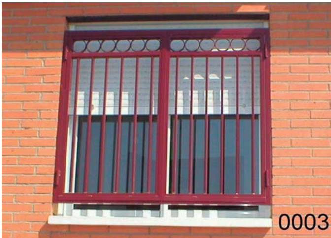
RE-0003: Reja abatible 2 hojas con cerradura, modelo simple de barrotes de tubo de 20*20 mm., faja superior con aros decorativos de pletina, imprimacion "wash primer" y lacado al horno rojo RAL 3005.
