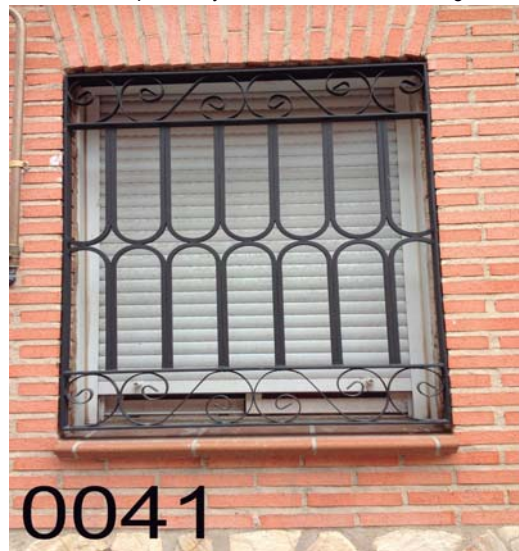
RE-0041: Reja fija de acero macizo, barrotes decorativos con arcos de cuadrado de 14*14 mm., 2 fajas horizontales con "S", imprimación "wash primer" y lacado al horno negro texturado.
