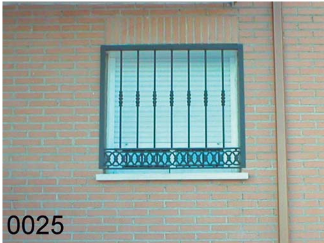
RE-0025: Reja fija modelo de barrotes de macizo de diam. 16 mm., solera inferior decorativa, macollas de fundido, imprimacion "wash primer" y lacado al horno oxirón gris.
