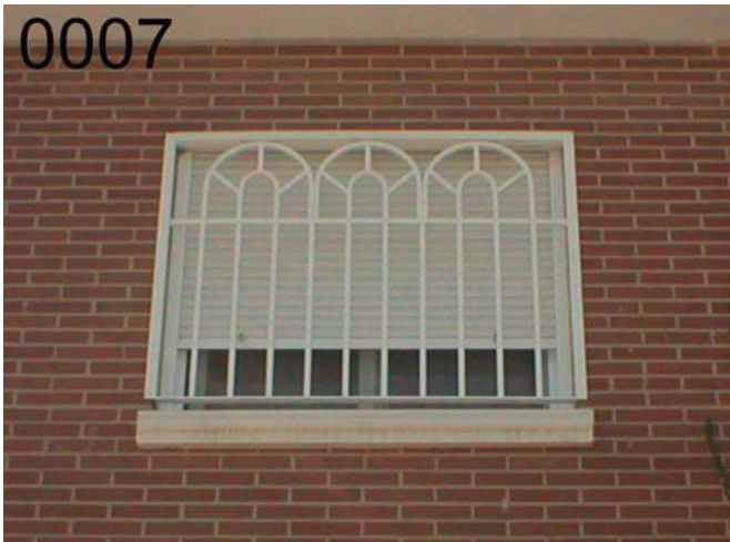
RE-0007: Reja fija "Estilo Inglés" de acero macizo, barrotes de cuadradillo de 16* 16 mm., con arcos y radios superiores, un refuerzo horizontal superior, imprimacion "wash primer" y lacado al horno blanco.
