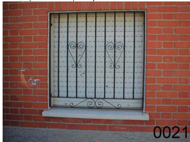
RE-0021: Reja fija modelo simple, barrotes de tubo 20*20 mm., con detalles decorativos en "S" central y parte inferior de pletina, imprimacion "wash primer" y lacado al horno blanco.
