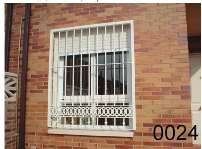
RE-0024: Reja fija modelo de acero macizo, barrotes de cuadradillo 16*16 mm., con solera y macollas decorativos, imprimacion "wash primer" y lacado al horno blanco.
