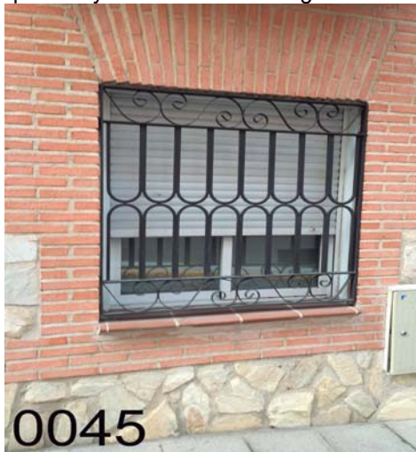
RE-0045: Reja fija de acero macizo, barrotes decorativos con arcos de cuadrado de 14*14 mm., 2 fajas horizontales con "S", imprimación "wash primer" y lacado al horno negro texturado.
