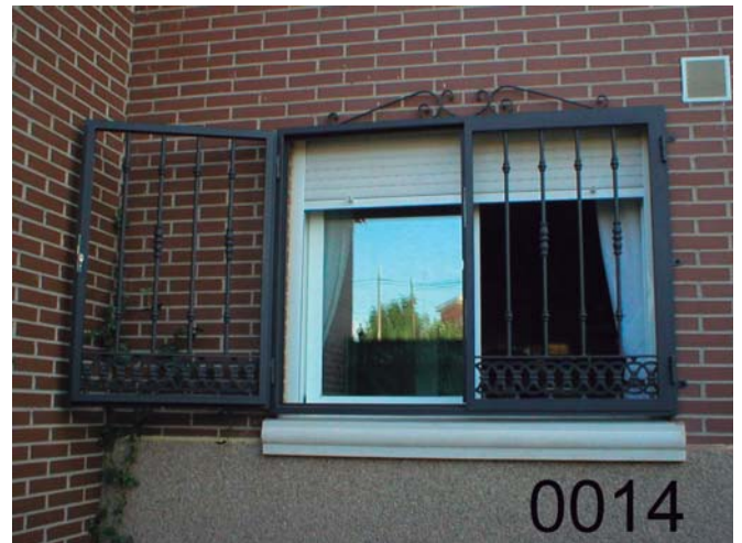
RE-0014: Reja abatible 2 hojas con cerradura, modelo de barrotes de macizo de diam. 16 mm., solera inferior decorativa, macollas de fundido, imprimacion "wash primer" y lacado al horno oxirón gris.
