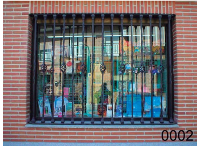
RE-0002: Reja fija de acero macizo, barrotes cuadrados 16*16 mm., con piñas centrales y macollas bases de fundido, salomonicos alternos, imprimacion "wash primer" y lacado al horno oxirón gris.
