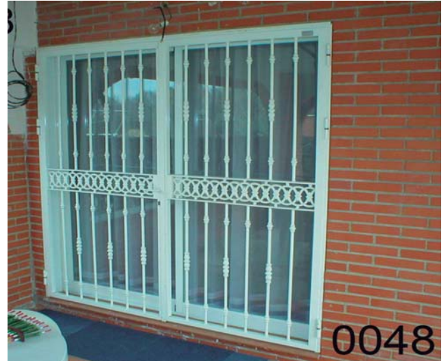
RE-0048: Puerta abatible 2 hojas, pernios con rodamiento axial, cerradura y manivela, modelo barrotes macizo diam. 16 mm., solera, macollas, imprimación "wash primer" y lacado al horno blanco.
