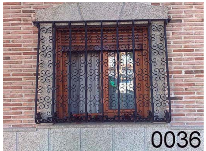
RE-0036: Reja artistica fija modelo de barrotes macizos de 16*16 mm. forma "pecho paloma", balaustre decorativo con "S" de pletina, imprimación "wash primer" y lacado al horno negro texturado.
