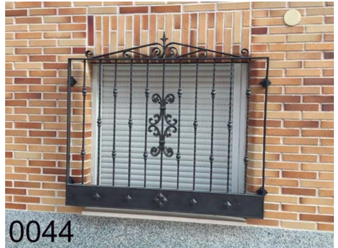
RE-0044: Reja fija de forja artística, modelo de barrotes forjados, parte superior decorativa, adorno central, faja inferior de chapa con remaches, imprimación "wash primer" y lacado al horno oxirón gris.
