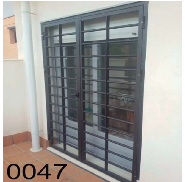
RE-0048: Puerta abatible 2 hojas, pernios con rodamiento axial, cerradura y manivela, modelo barrotes macizo diam. 16 mm., solera, macollas, imprimación "wash primer" y lacado al horno blanco.
