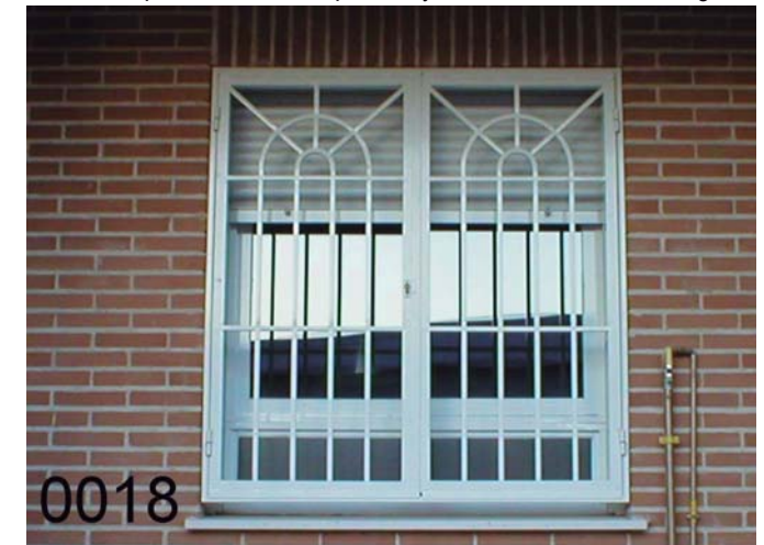
RE-0018: Reja abatible 2 hojas con cerradura, modelo "Estilo Inglés" de acero macizo, barrotes de cuadradillo 16*16 mm., con arcos y radios superiores, 3 refuerzos horizontales, imprimacion "wash primer" y lacado al horno blanco.
