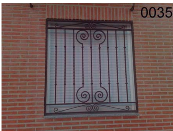
RE-0035: Reja fija modelo de acero macizo, barrotes de cuadradillo 14*14 mm. con rizados, detalles decorativos forja, macollas, imprimación "wash primer" y lacado al horno oxirón marrón.
