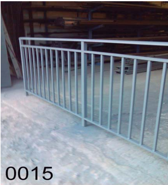
BB-0015: Barandilla simple y económica de tubo hueco, barrotes de 20*20 mm., pilastras de 40*40 mm., horizontales de 40*20 mm., pasamanos media caña 50*25 mm., mano de imprimacion gris.
