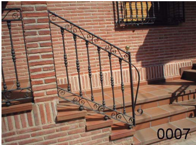
BB-0007: Tiro escalera de acero macizo, barros de diam. 16 mm., con macollas centrales y bases de fundido, detalles decorativos de pletina, pasamanos, imprimacion "wash primer" y lacado al horno oxirón gris.
