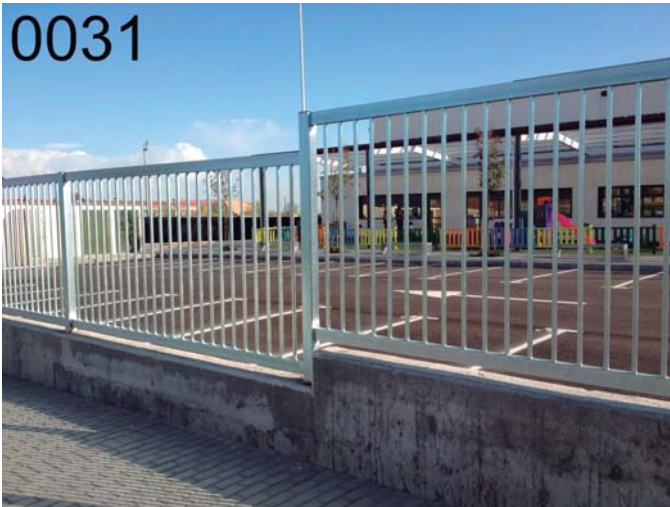
BB-0031: Vallas de barrote 20*20 mm., cercos de tubo de 60*40 mm., postes de tubo de 60*60 mm., acabado cincado en frío.
