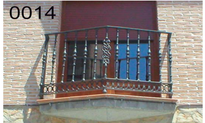
BB-0014: Balcón de acero macizo, barrotes enterizos decorativos fundidos, con adorno central, solera de aros, pasamanos, imprimacion "wash primer" y lacado al horno oxirón gris.
