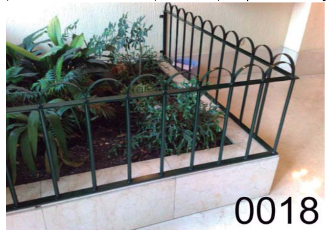
BB-0018: Barandilla de jardín de acero macizo, barrotes de diam. 16 mm., con formas medio punto superiores de pletina de 16*3 mm., pletinas macizas superior e inferior de 30*8 mm., imprimacion "wash primer" y lacado al horno verde.
