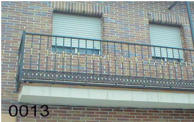
BB-0013: Balcón de acero macizo, barrotes de diam.16 mm., con macollas centrales y anillos, y piñas de laton dorado, solera de aros decorativa, pasamanos, imprimacion "wash primer" y lacado al horno oxirón gris.
