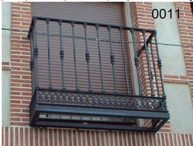
BB-0011: Balcón de acero macizo, barros de cuadradillo 16*16 mm., con macollas centrales y bases de fundido, solera de aros decorativa, rizados, pasamanos, imprimacion "wash primer" y lacado al horno oxirón gris.
