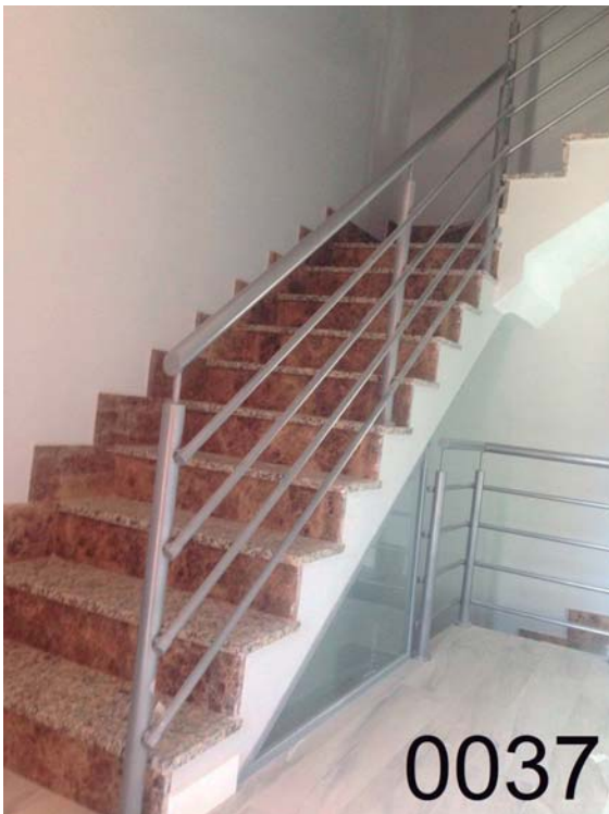
BB-0037: Tiro de escalera de tubos horizontales de diam. 25 mm., verticales y pasamanos de diam. 40 mm., imprimacion "wash primer" y lacado al horno gris plata metalizado RAL 9006.
