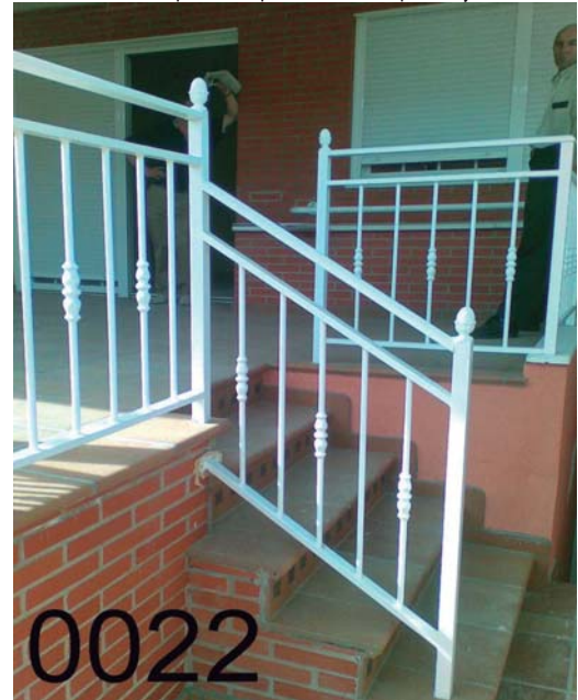
BB-0022: Tiro escalera y barandillas mixto simple, barrotes de diam. 16 mm., con macollas centrales, pilastras de 40*40 mm., piñas, horizontales de 40*20 mm., pasamanos media caña 50*25 mm., imprimacion "wash primer" y lacado al horno blanco.
