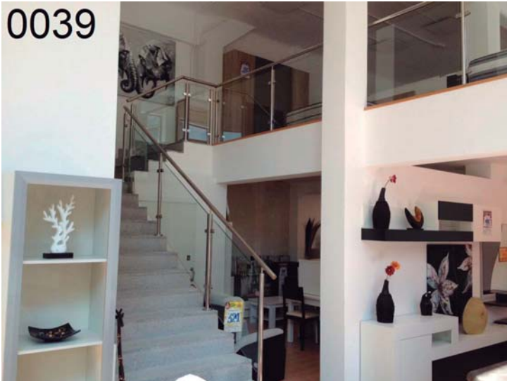
BB-0039: Tiro escalera y barandillas de acero inoxidable modular y lunas laminaras, pilastras, pinzas y pasamanos, montaje con plafones y escudos, acabado pulido brillo
